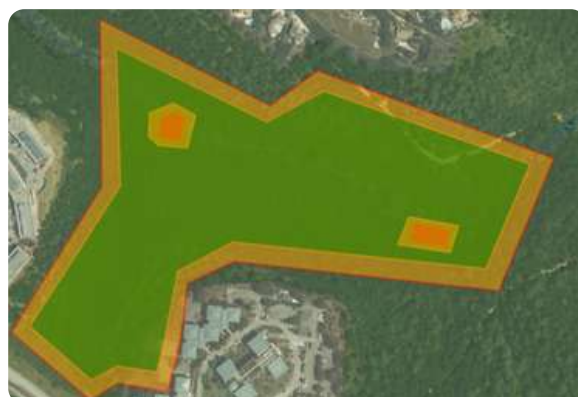
Exemple fence complète valide avec NFZ.
