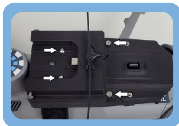
Placer les vis à tête plate à l'avant et les vis à tête bombées à l'arrière et visser
