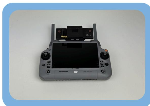
Fixer la radiocommande Flysafe sur la radiocommande du drone avec la porte vis
