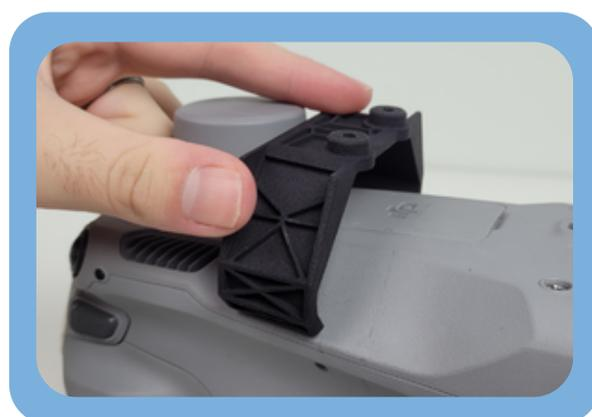
Insérer le support sur le drone
