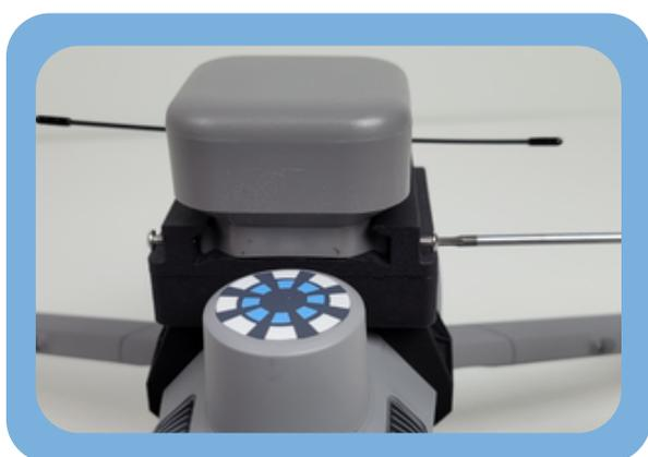
Fixer les vis sur les côtés afin d'assurer un bon maintien du parachute
