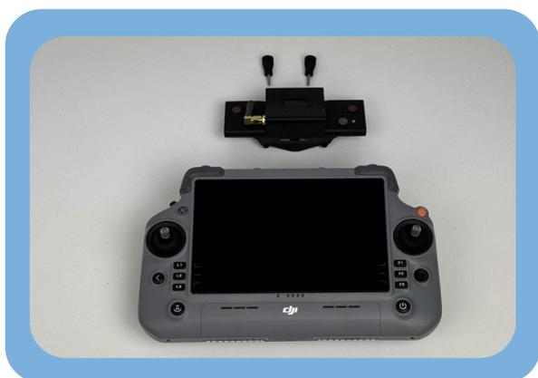
Se munir de la radiocommande Flysafe, la radiocommande du drone ainsi que des vis
