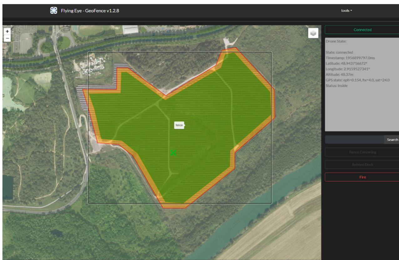
Lors de l'utilisation du FTS avec la radiocommande web, la géofence n'est configurable qu'à l'installation du système. Pour la modifier, veuillez contacter Flying Eye
