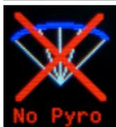
Les charges pyrotechniques ne sont pas connectées. Veuillez vérifier le montage du parachute.
