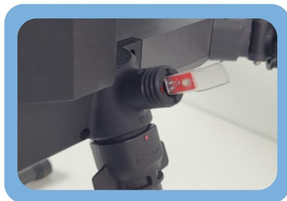
Mettre les 2 leds test dans les emplacements des charges
