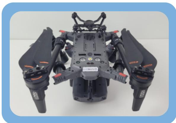
Retourner et poser le drone sur une surface souple pour ne pas l'abimer
