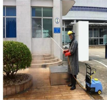
图片 2 水雾灭火器 (穿着 PPE 防止触电)
