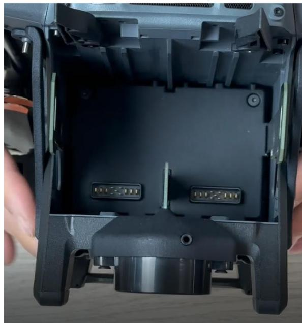
Insérer les batteries du M30 jusqu'au fond puis les verrouiller avec les loquets précédemment installés (garder le drone éteint) :
