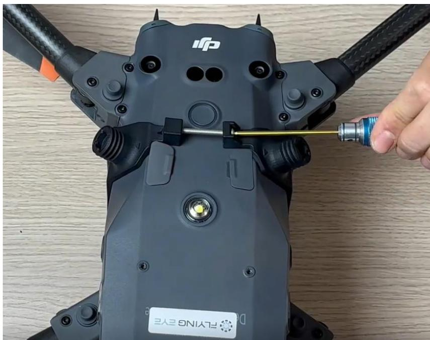
Insérer les languettes électroniques sur le module batterie comme ci-dessous :
