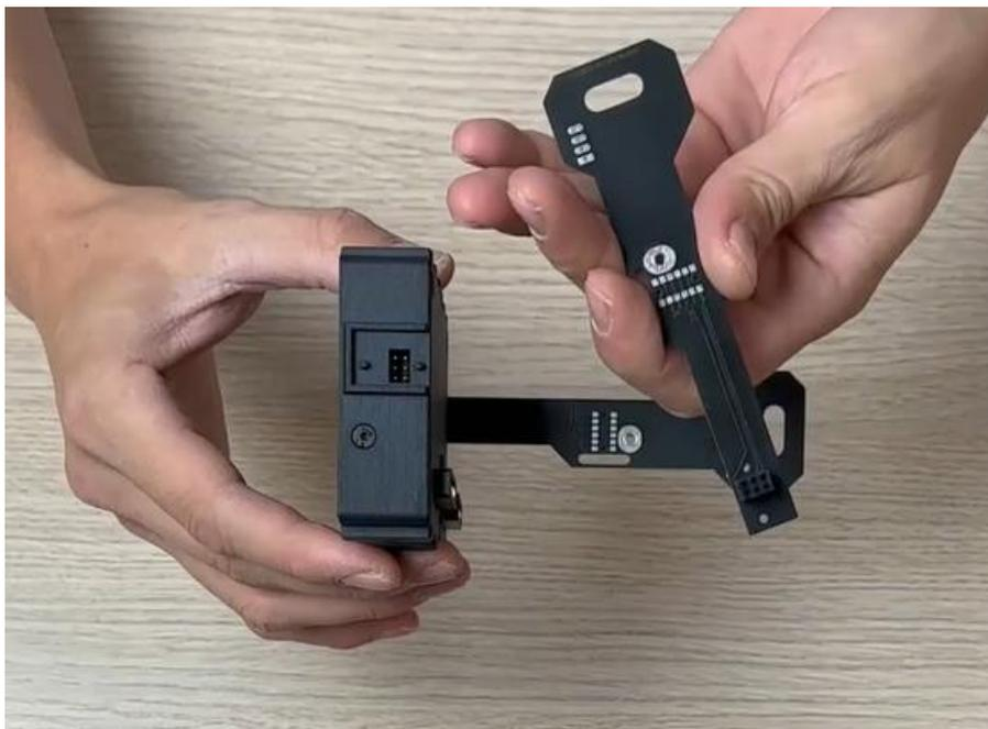
Insérer le tout dans le logement batteries du M30 (jusqu'au fond) en poussant légèrement les languettes vers l'intérieur afin que celles-ci ne frottent pas contre la paroi :
