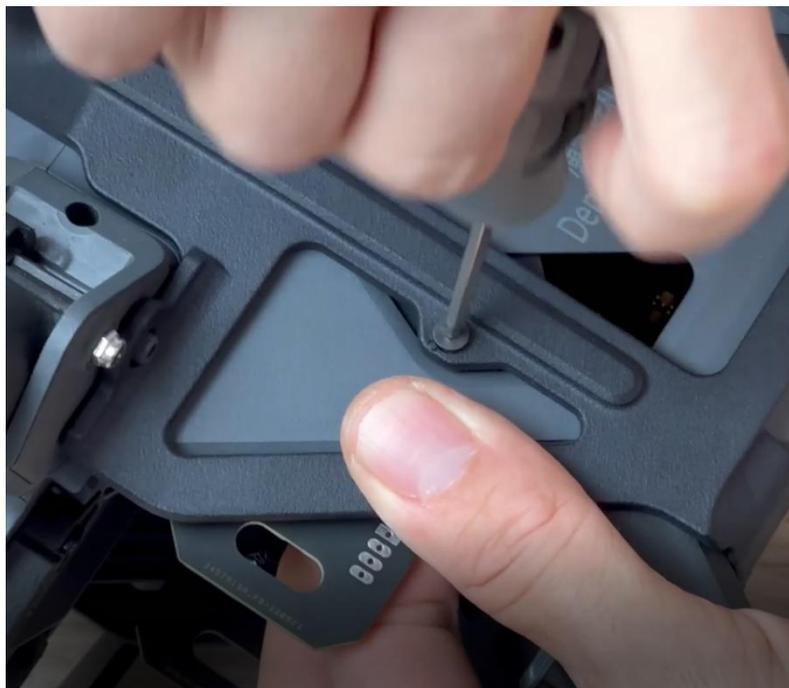
Insérer ensuite le buzzer (légèrement en biais) sur le module batterie puis le recentrer une fois inséré :
