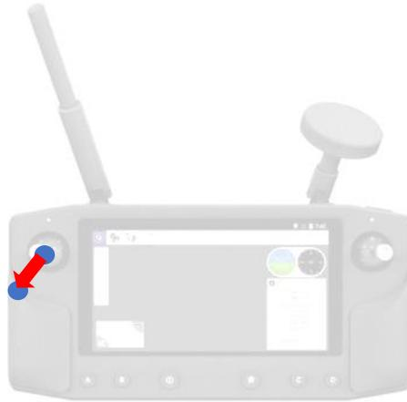
*Exemple de coupure des moteurs sur une radiocommande HERELINK*
