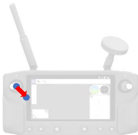
*Exemple de démarrage des moteurs sur une radiocommande HERELINK*
