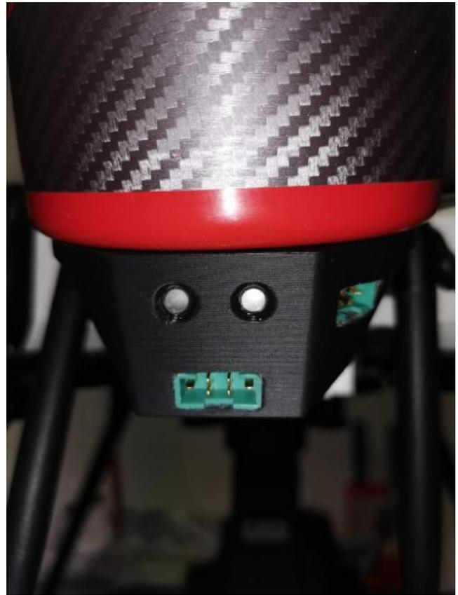
Une clef de sécurité est située à l'arrière de l'aéronef. Elle empêche un déclenchement accidentel de la charge pyrotechnique et doit-être retirée avant tout autre étape de mise en route.
