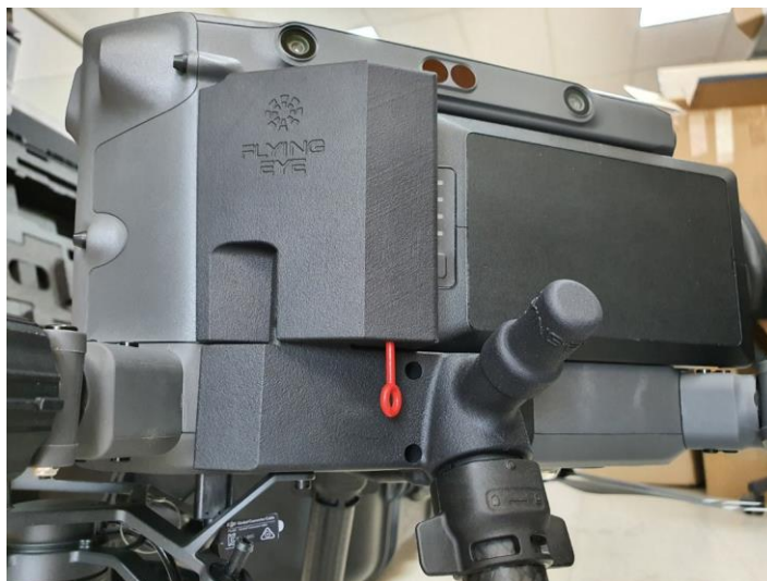
Goupille de sécurité en place
