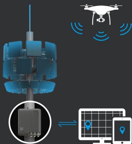
Le DJI AeroScope est un système de détection anti-drone. Contrairement aux autres systèmes disponibles sur le marché qui utilisent un radar ou des caméras pour détecter les drones, ce détecteur intercepte les données transmises entre la radiocommande et les drones environnants. Le DJI AeroScope détermine ainsi avec précision leur position, altitude, vitesse, numéro de série et modèle. Il permet aussi d'identifier précisément la position du pilote.
